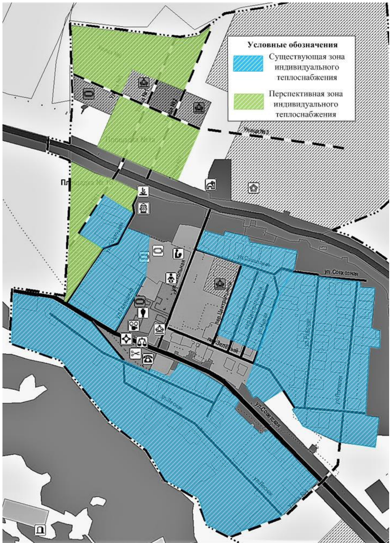
Рис. № 13 – Существующие и перспективные зоны действия индивидуального теплоснабжения на территории села Красносельское
